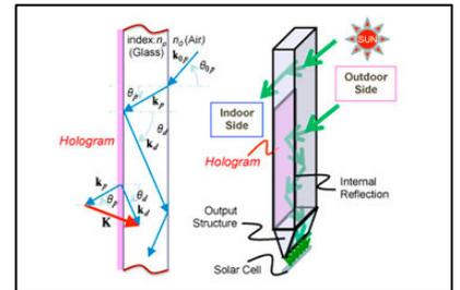
ホログラム技術を窓ガラスに応用した「Holo-Window」というコンセプトの、全く新しい太陽光発電方式を考案しました。この技術が確立すれば、BIPV市場に新たな高付加価値の創出を期待することができます。
