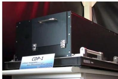
全視差のある三次元画像を部分ホログラムと微小ホログラムに分割し、それをシート状のホログラフィック記録媒体に露光することにより、ホログラフィックに三次元立体画像を印刷する印刷システム。印刷された三次元立体画像はシートの前後に再現され、三次元的に観察することができます。
