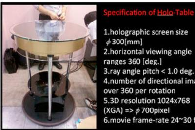
ホログラムによる光偏向機能と高速空間変調デバイス (SLM) の特徴を組み合わせ、裸眼による自然な立体視が可能な3Dディスプレイ装置を開発しました。360度の方向から観察できるRGBカラー・3D立体映像を、テーブルの中央に浮かび上がらせて表示します。
